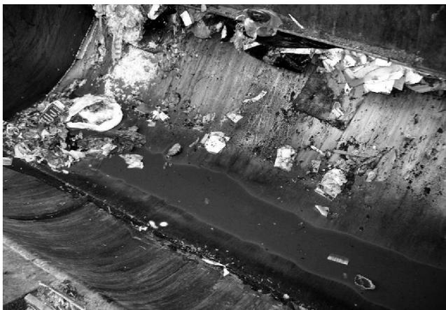
**Figura 3** – Chorume na calha do dreno do caminhão coletor.
