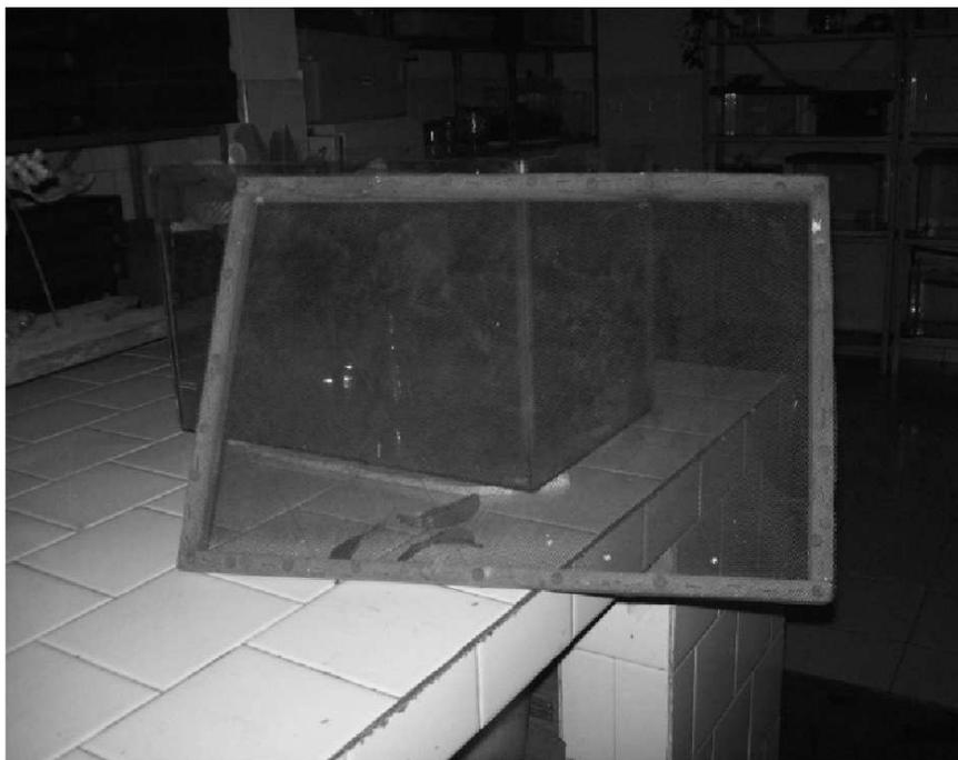
**Figura 4** - Tampa feita de madeira e cobertura com tela de náilon. Foto: Ademar FS/2010.
